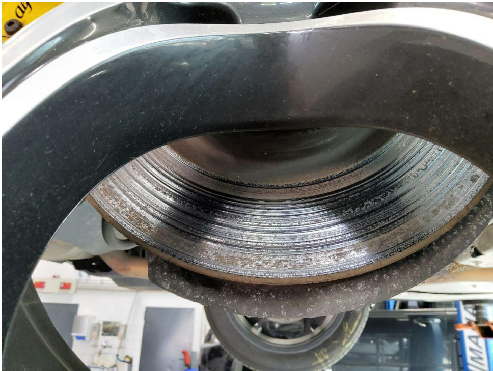
Bild 11 : Bremsscheiben hinten, stark verschlissen und schlechtes Tragbild
