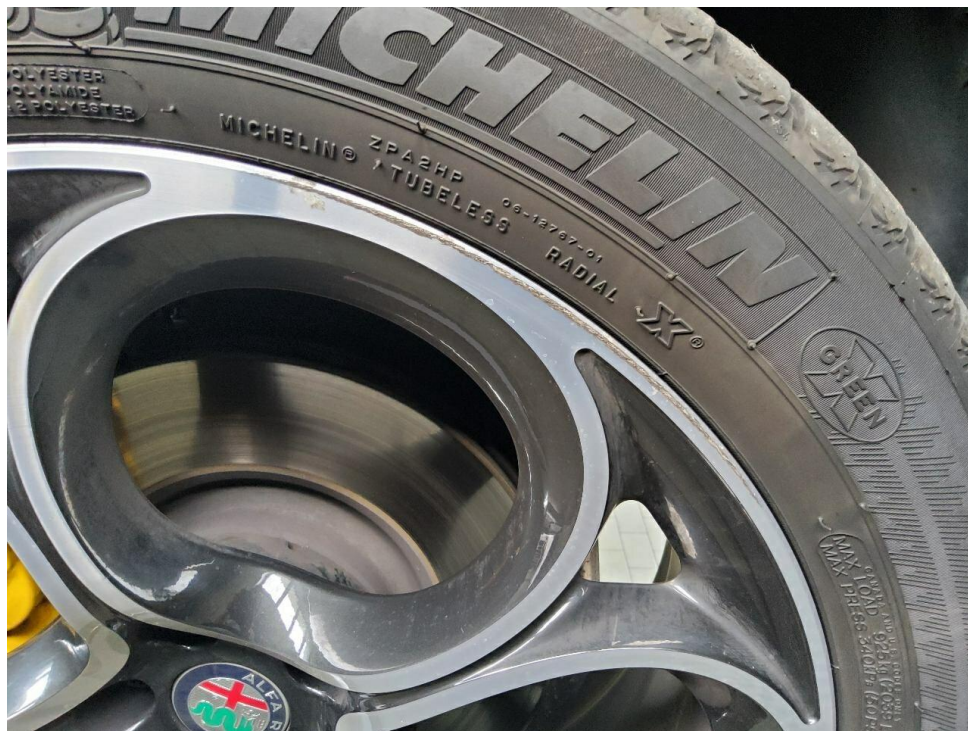
Bild 10 : Felge vorn rechts, verschrammt
