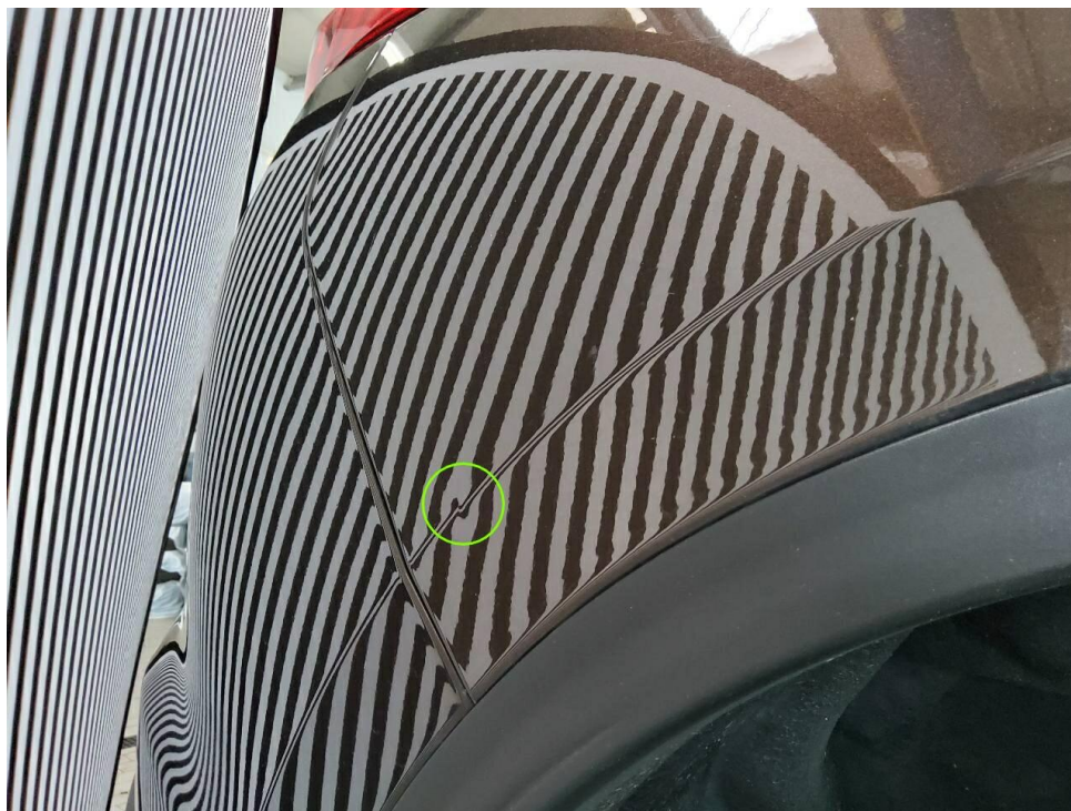
Bild 14 : Seitenwand rechts, eingedrückt
