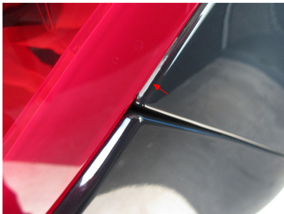
Bild 6 : Seitenwand hinten rechts, Lack blättert an der Rückleuchte ab
