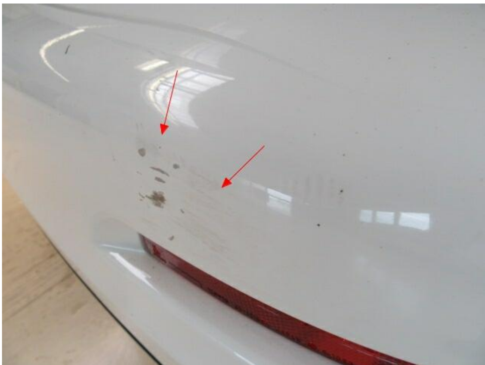
Bild 40 : Stoßfänger hinten Lackierung, zerkratzt, lackieren
