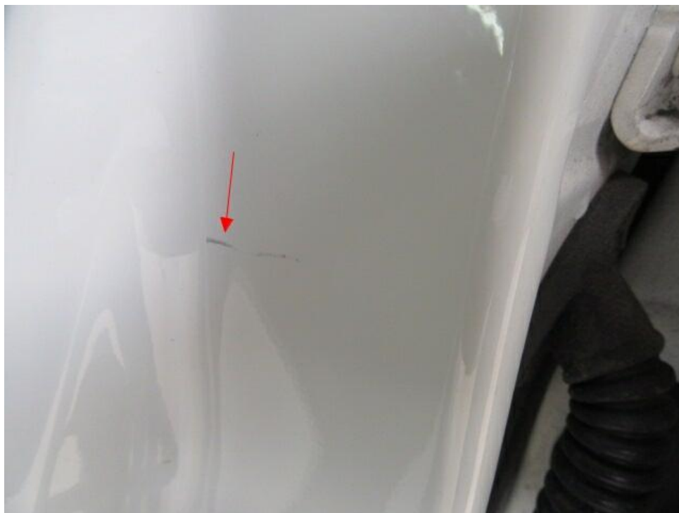
Bild 33 : Türeinstieg hinten rechts eingedellt
