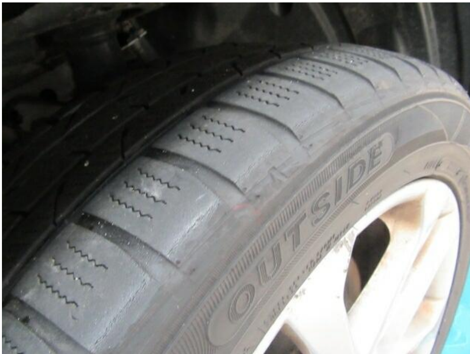
Bild 44 : Reifen vorne seitlich abgefahren
