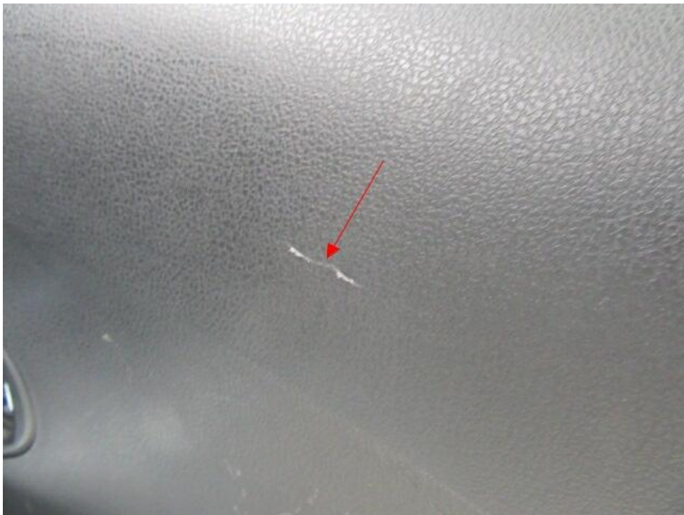
Bild 30 : Türverkleidung hinten rechts verkratzt
