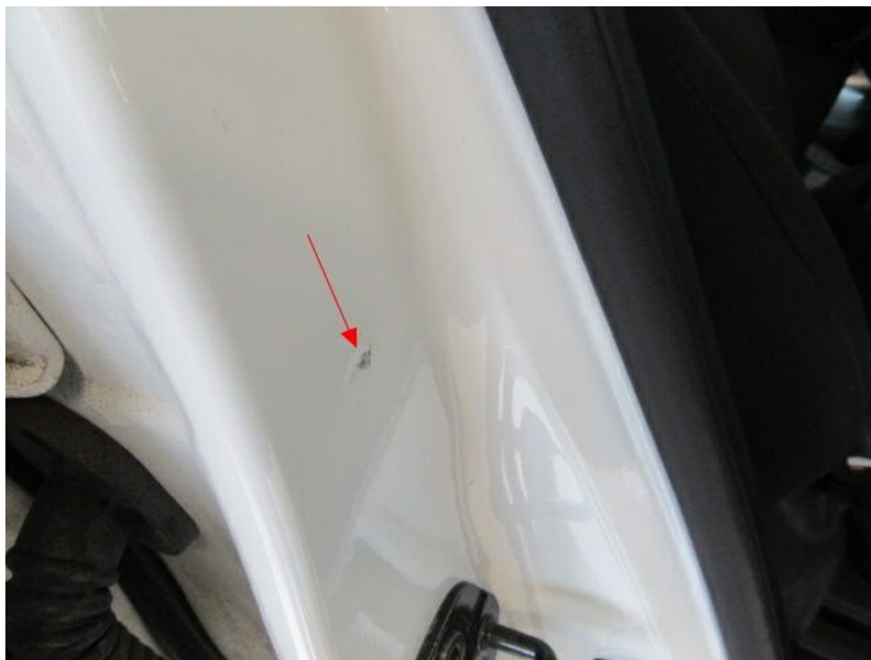
Bild 32 : Türeinstieg vorne rechts eingedellt
