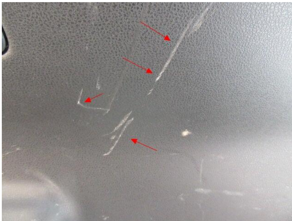
Bild 31 : Heckklappenverkleidung mehrstellig verkratzt
