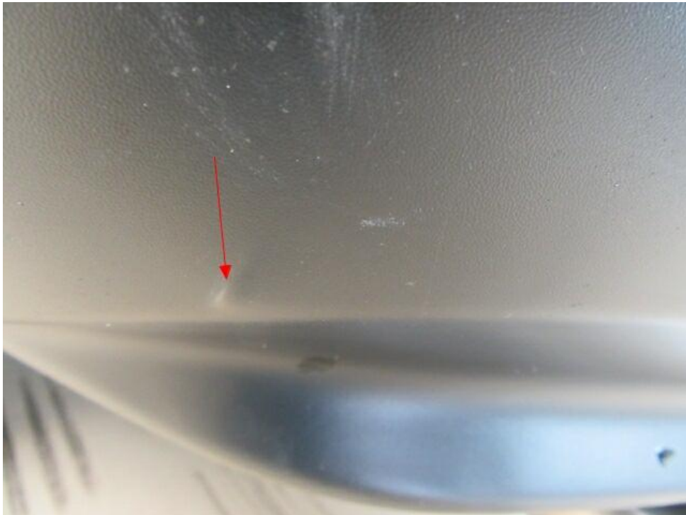
Bild 43 : Stoßfängerunterteil hinten verkratzt
