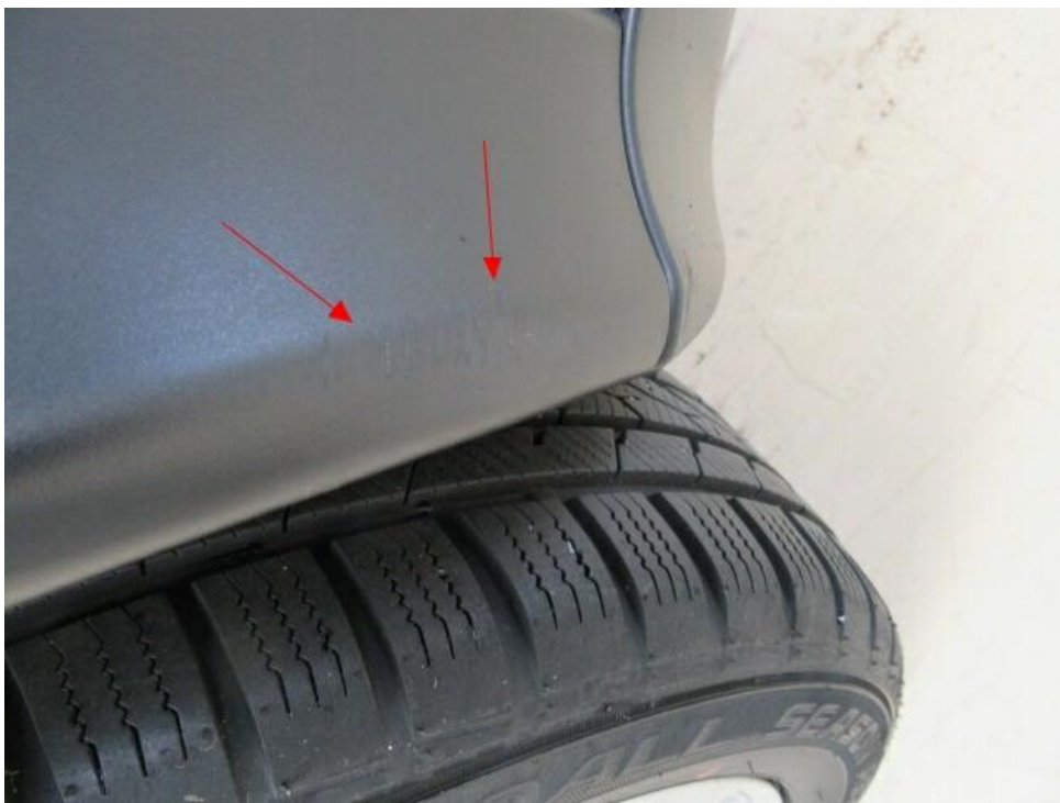
Bild 38 : Verbreiterung Seitenteil links verkratzt
