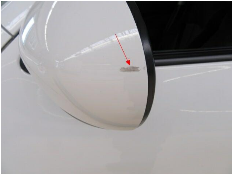
Bild 42 : Außenspiegel links verkratzt
