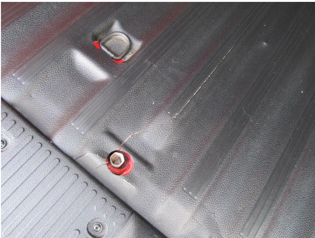
Bild:14 Kofferraumbelag gebrochen
