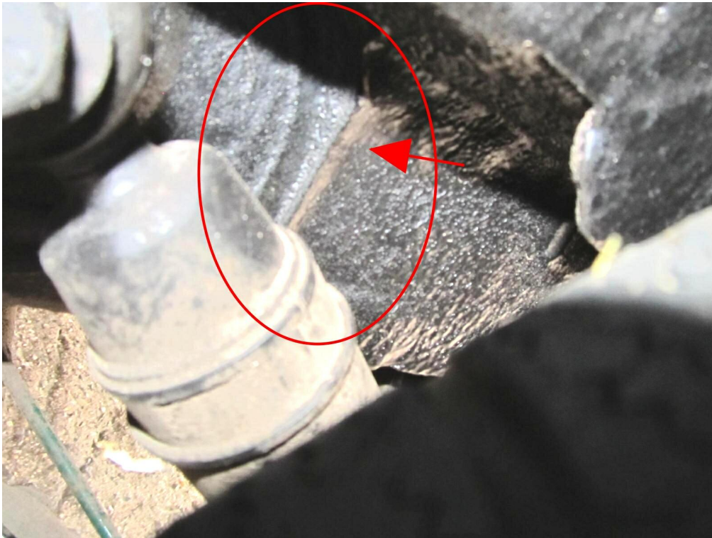
Bild:19 Knick/Stauchung Längstäger links
