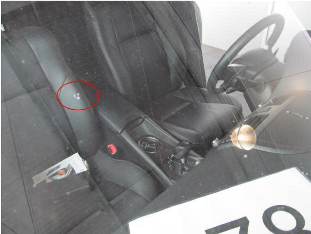
Bild:13 Erheblich Steinschläge in Frontscheibe tw. mit Rissbildung
